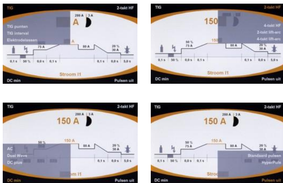
Fig. 5: Bedieningspaneel VERTIGO digital / Applicatie Classic Beeld van de vier Pull down menu's voor de multifunctietoetsen
